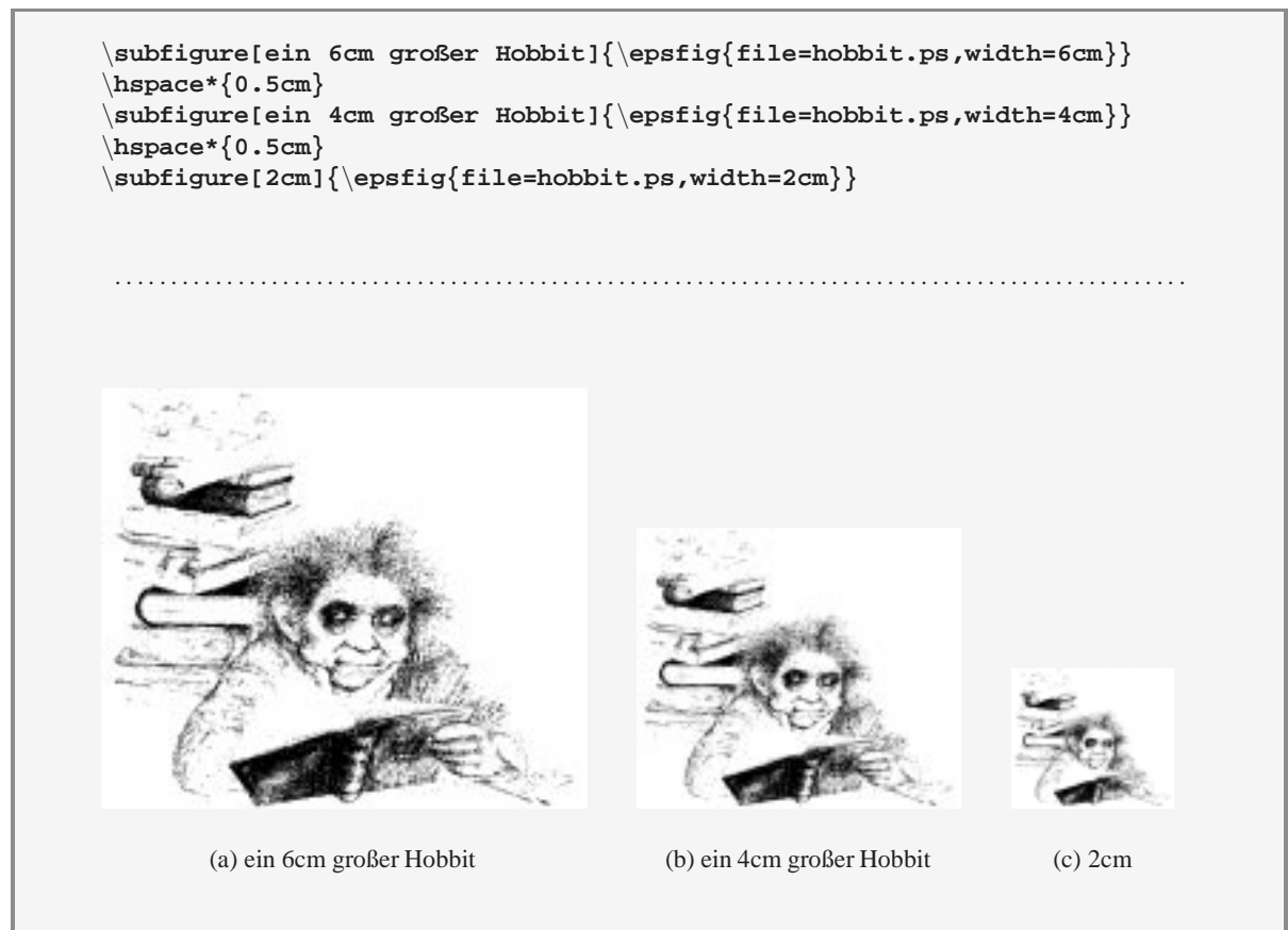
Abbildung 71: Geschachtelte Abbildungen mit dem subfigure-Paket
